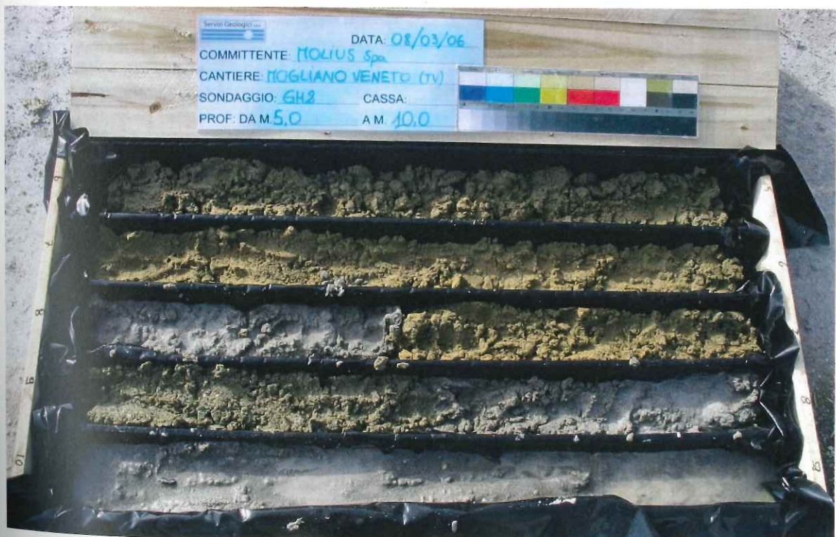
Foto 12: sondaggio GH2 da 5.00 a 10.00 m
