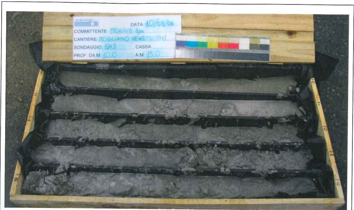
Foto 17: sondaggio GH3 da 10.00 a 15.00 m
