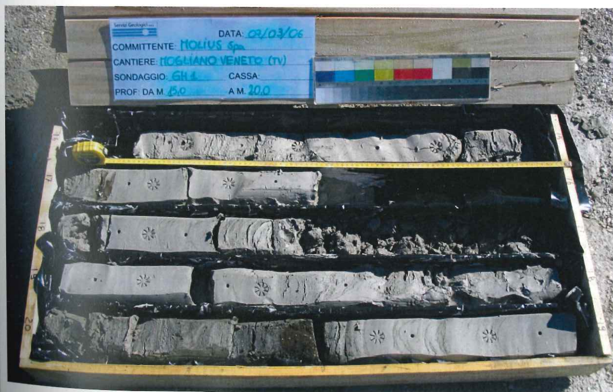
Foto 10: sondaggio GH1 da 15.00 a 20.00 m
