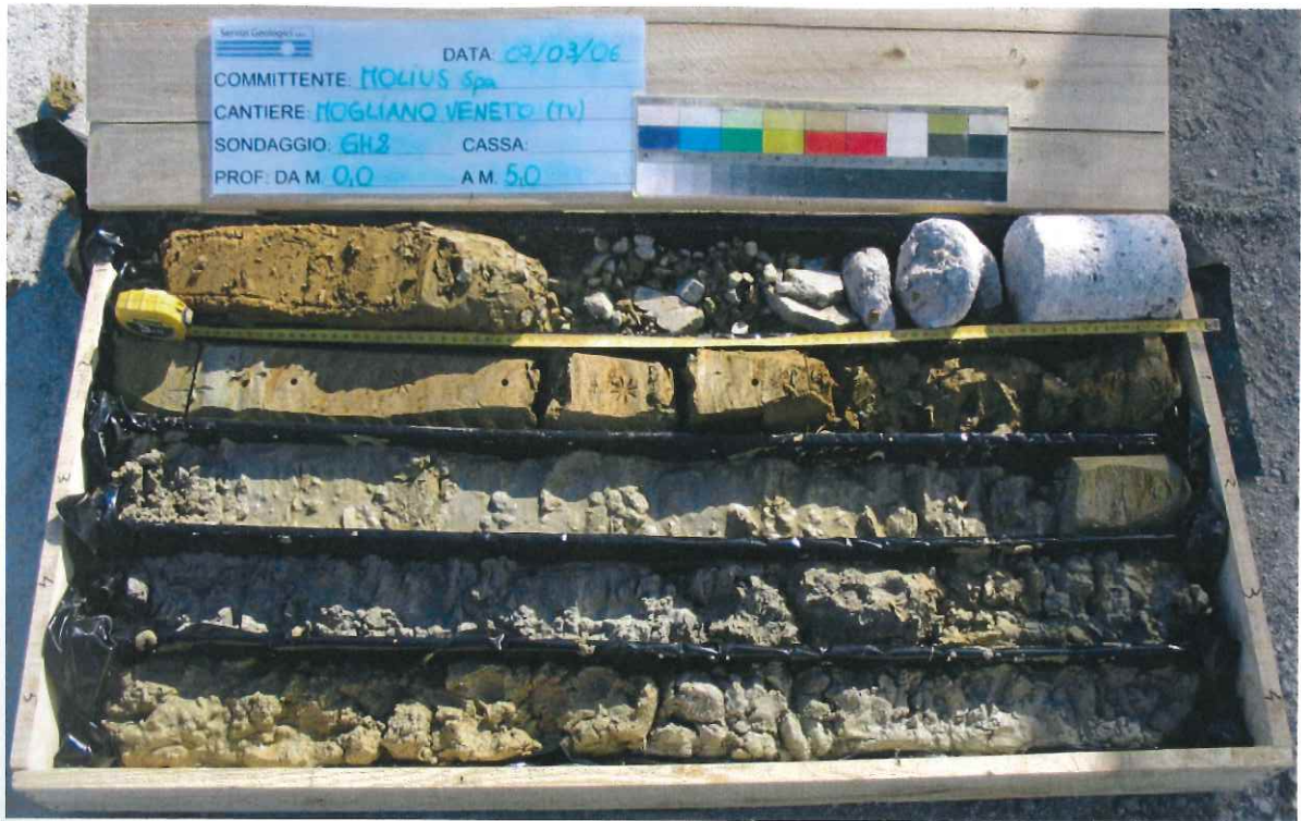
Foto 11: sondaggio GH2 da 0.00 a 5.00 m
